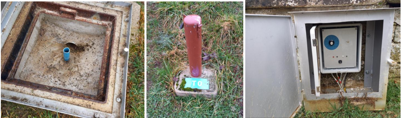
Piézomètres ouverts de la digue principale (en crête et sur le talus) / Boîtier de commutation des cellules en crête
